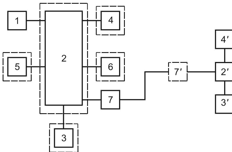
1 — извещатель; 2, 2' — установка управления; 2 — охранный (охранно-пожарный) приемно-контрольный прибор, 2' — пульт централизованного наблюдения; 3, 3' — источник электропитания; 4, 4' — световой и/или звуковой оповещатель; 5 — устройство, управляемое установкой управления; 6 — программируемое входное устройство; 6 — шифрующее устройство; 7, 7' — сигнальный интерфейс, modem; 7, 7' — система передачи извещений
