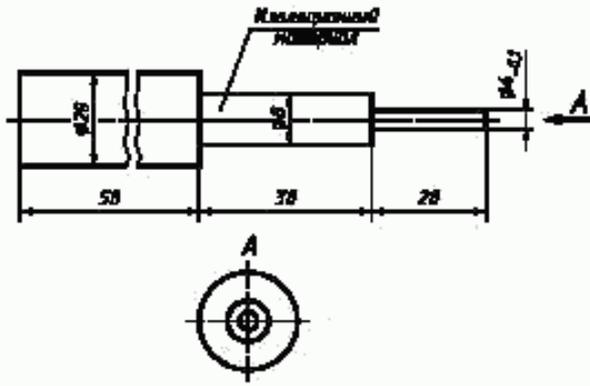
Рисунок Г.3 — Стандартный испытательный штырь
