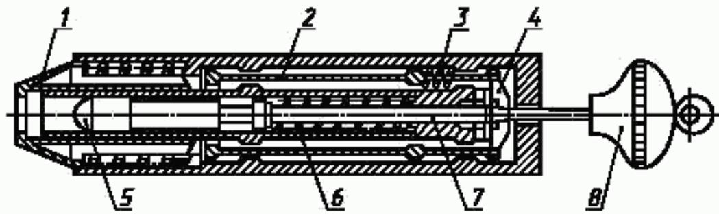
1 — выходной конус; 2 — стержень спускового механизма; 3 — пружина спускового механизма;
