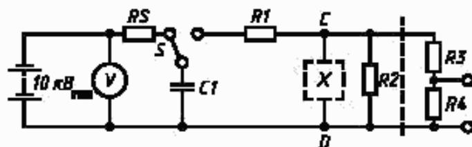
$X$  — испытуемый аппарат;  $R1$  — резистор с сопротивлением 1 кОм;  $R2$  — резистор с сопротивлением 4 кОм;  $R3$  — резистор с сопротивлением 100 МОм;  $R4$  — резистор с сопротивлением 0,3 МОм;  $R5$  — резистор с сопротивлением 15 МОм;  $C1$  — конденсатор емкостью 1 нФ;  $V$  — вольтметр постоянного напряжения;  $C$ ,  $D$  — клеммы для подключения испытуемого аппарата;  $S$  — переключатель
