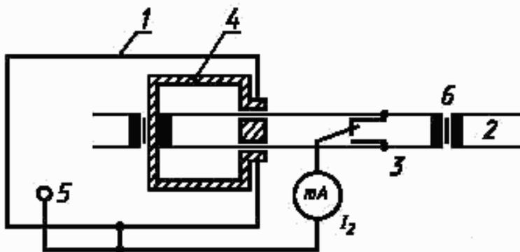
1 — доступные для прикасания токопроводящие части или металлическая фольга, в которую обернут аппарат; 2 — сеть электропитания; 3 — переключатель измерений; 4 — дополнительная (защитная) изоляция, если она есть; 5 — зажимы измерительного заземления;  $mA$  — миллиамперметр переменного тока; 6 — разделительный трансформатор
