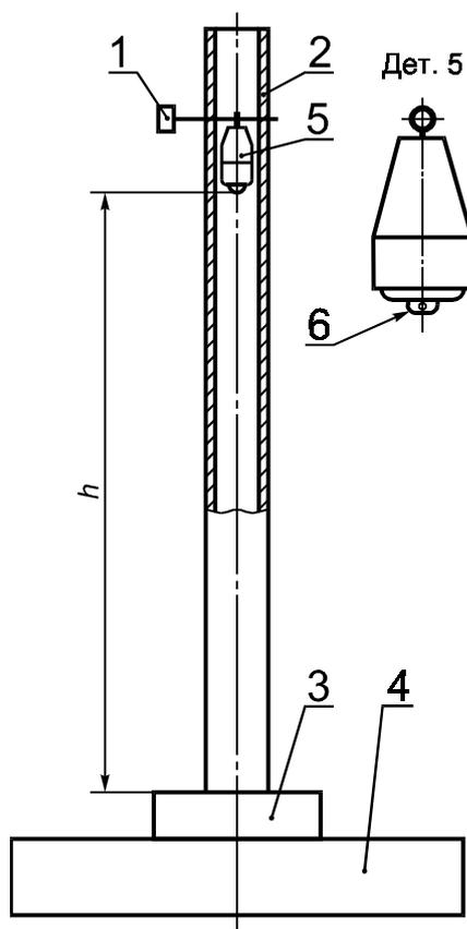
1 — регулировочный штифт; 2 — пластмассовая направляющая труба; 3 — испытуемый образец; 4 — стальная основа (масса  $\geq 20$  кг); 5 — стальной груз массой 1 кг; 6 — ударная головка в форме сферы диаметром 25 мм из закаленной стали;  $h$  — высота падения
