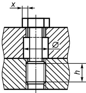
$\varnothing$  — отверстие со стандартным зазором для прохода резьбы соответствующей формы.
