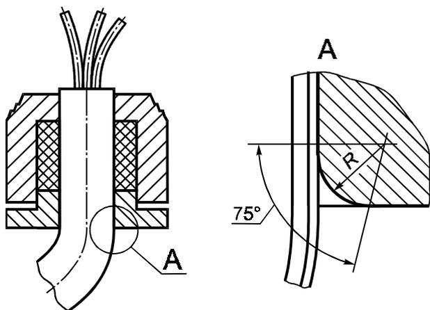
Рисунок В.2 — Скругление кромок в месте ввода гибкого кабеля
