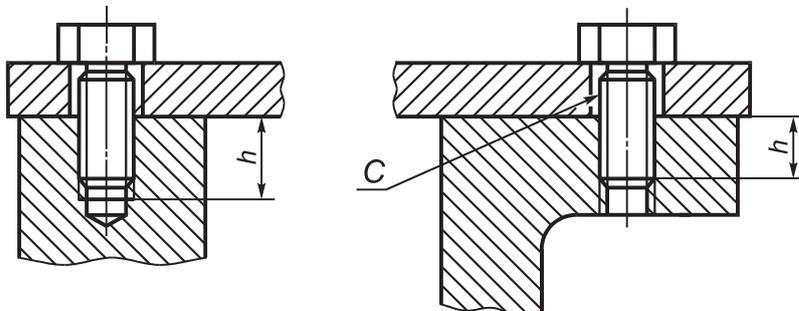
Размер  $h$  должен быть не менее основного диаметра резьбы крепежной детали.
