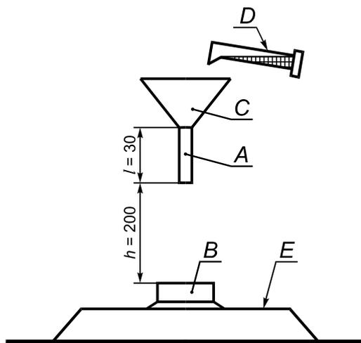
A — трубка воронки длиной  $l = 30$  мм внутренним диаметром 8 мм; B — прибор для испытания; C — воронка; D — сосуд с 30 мл соляного раствора; E — горизонтальная поверхность;  $h$  — высота расположения нижнего конца трубки воронки относительно прибора
