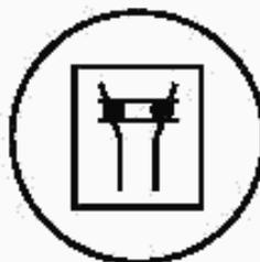
Рисунок L.2 — Символ маркировки аппарата, содержащего механически связанные контакты
