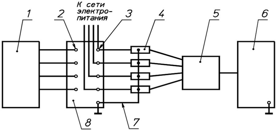
1 — нагрузка, внешнее устройство; 2 — зажим для подключения нагрузки, внешнего устройства; 3 — зажим сети электропитания; 4 — разделительное устройство пробника напряжения; 5 — переключатель фаз; 6 — измеритель радиопомех; 7 — провод, соединяющий разделительные устройства пробника напряжения с зажимом на корпусе устройства; 8 — испытуемое устройство
