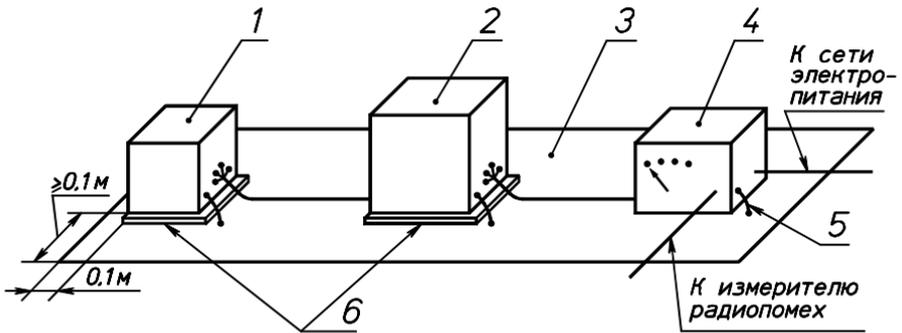
1 — нагрузка, внешнее устройство; 2 — испытуемое устройство; 3 — металлический лист; 4 — эквивалент сети; 5 — шина заземления; 6 — прокладка из изоляционного материала
