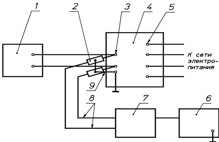
1 — нагрузка, внешнее устройство; 2 — разделительное устройство пробника напряжения; 3 — зажим для подключения нагрузки, внешнего устройства; 4 — испытываемое устройство; 5 — зажим для подключения сети электропитания; 6 — измеритель радиопомех; 7 — переключатель фаз; 8 — соединительные коаксиальные кабели; 9 — провод, соединяющий разделительные устройства пробника напряжения с зажимом на корпусе испытываемого устройства
