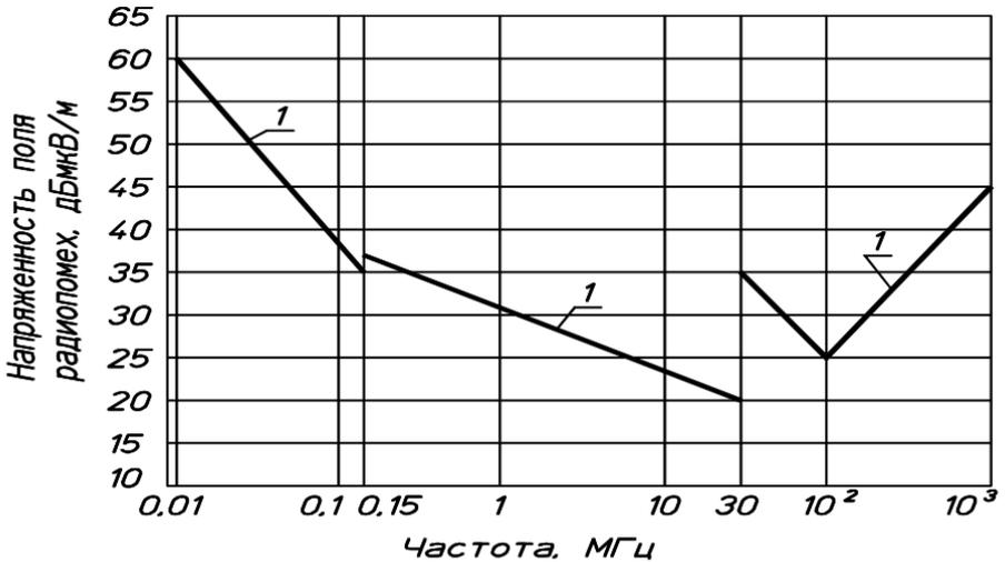
Рисунок 2 — Нормы напряженности поля радиопомех
