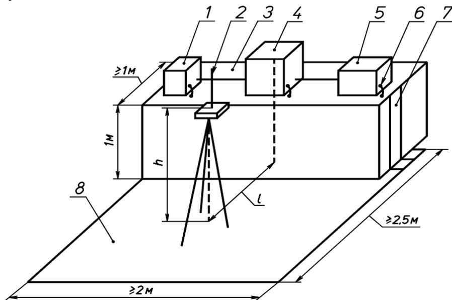
1 — нагрузка, внешнее устройство; 2 — антенна; 3 — стенд для проведения измерений; 4 — испытуемое устройство; 5 — эквивалент сети; 6 — шина заземления эквивалента сети; 7 — соединительная шина; 8 — металлический лист;  $h$  — высота установки антенны;  $l$  — расстояние между проекциями на землю центра антенны и ближайшей точки корпуса устройства
