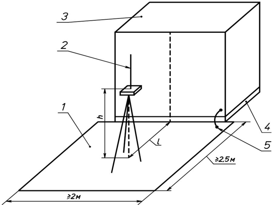
1 — металлический лист; 2 — антенна; 3 — испытуемое устройство; 4 — прокладка из изоляционного материала; 5 — шина заземления испытуемого устройства;  $h$  — высота установки антенны;  $l$  — расстояние между проекциями на землю центра антенны и ближайшей точки корпуса устройства
